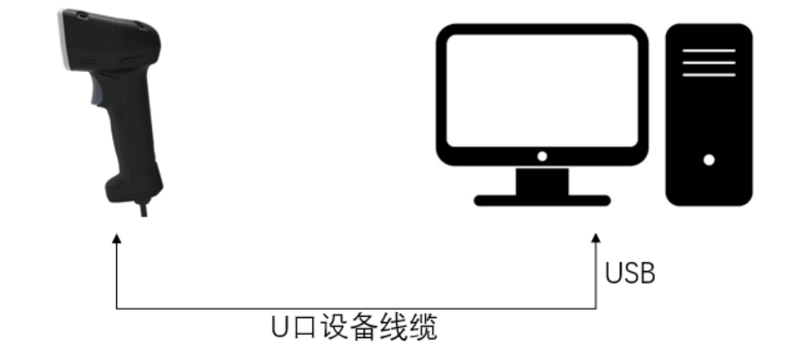
图 3-2 U 口设备接线方式图
