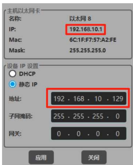
图 3-12 设备 IP 地址和主机 IP 在同一网段
