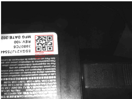
图 4-34 解码结果不符合字符长度时示意图
