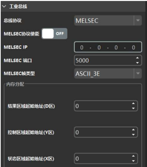
图 4-53 MELSEC 通信协议配置界面
