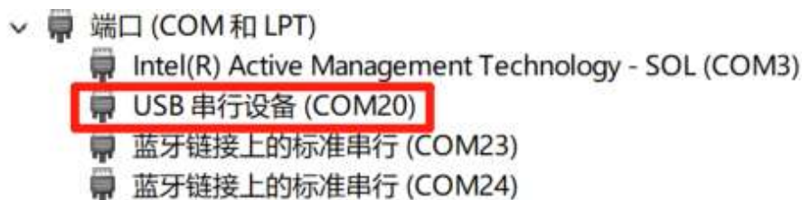
图 3-7 U 口设备驱动安装成功
