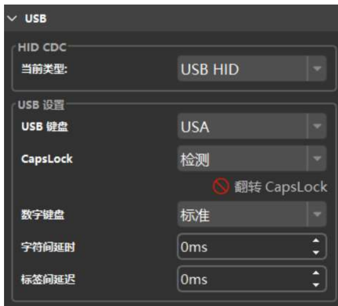
图 4-47 USB 通信协议配置界面
