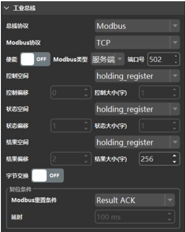
图 4-52 Modbus TCP 通信协议配置界面
